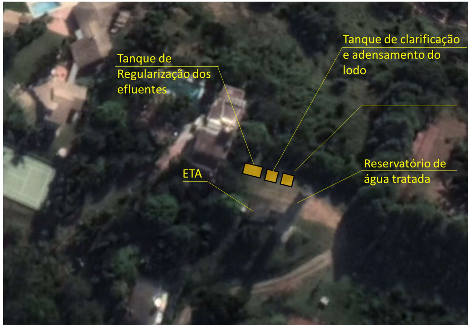
Figura 17 ETA II Layout preliminar de implantação do sistema de tratamento dos efluentes
