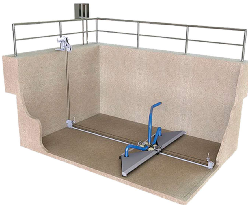
Figura 2 Alternativa 1 - Dispositivo móvel de remoção de lodo
